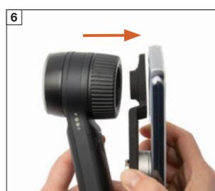
Магнитный адаптер фиксирует смартфон вместе с чехлом на фокусирующем кольце дерматоскопа.
